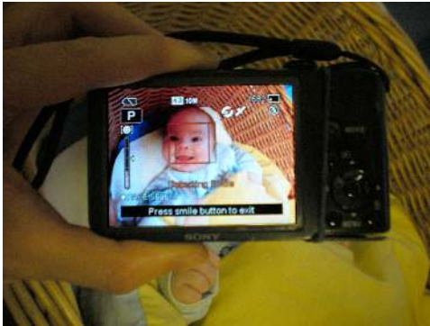
Abbildung 1: Die Sony Cyber-Shot DSC-HX5 von 2010 hat einen Modus, in dem automatisch ein Foto ausgelöst wird, wenn ein Lächeln erkannt wird. Die erforderliche Stärke des Lächelns für die Auslösung kann in drei Stufen eingestellt werden: normal, mittel und stark.
